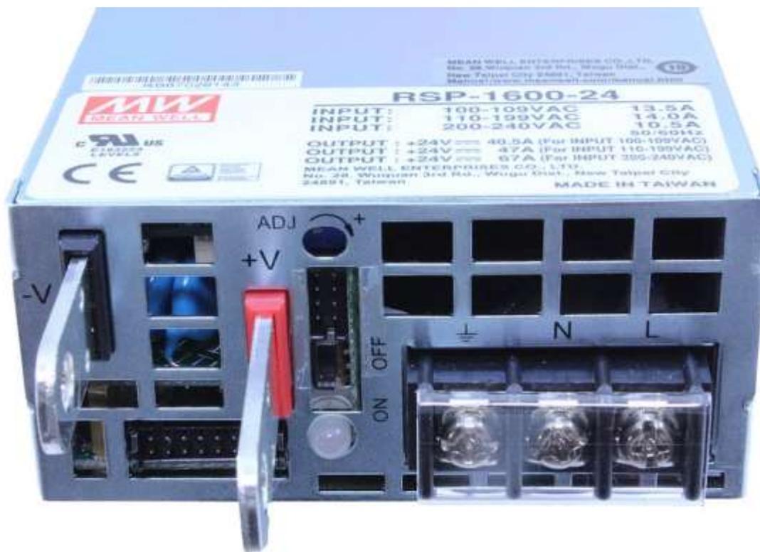
Trae incorporado **PM Bus Rev1.1** un protocolo de comunicaciones basado en I2C (Bus de datos serial, con circuito Inter – integrado), empleado para realizar la gestión centralizada de los sistemas de respaldo de energía. Esta interfaz permite monitorear el estado del equipo, alarma, marca y modelo del fabricante. Muestra **Voltage, corriente de salida, temperatura interna**. Se puede ajustar la configuración.
